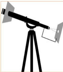
La plupart des lunettes sont livrées avec un écran blanc de projection solaire, mais vous pouvez laisser libre cours à vos talents de bricoleur pour en fabriquer un. Pour les instruments de diamètre supérieur à 100 mm, il est conseillé de diaphragmer l'objectif pour réduire l'échauffement de l'instrument. Ne pas oublier également de protéger le chercheur. □
