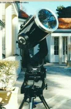
Si vous utilisez un instrument d'optique, il faut impérativement le munir d'un filtre de pleine ouverture, c'est-à-dire un filtre qui se place **DEVANT** l'objectif, à l'entrée du tube de la lunette ou du télescope. Ces filtres sont disponibles auprès de votre revendeur. Ne jamais utiliser de filtre d'oculaire.
